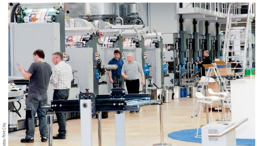
Über ein Gallus-ICS-670-Drucksystem ist eine effiziente Produktion inline produzierter Faltschachteln mit einem sehr hohen Grad an Veredelung möglich.
